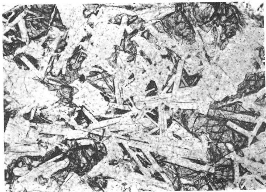
Рис. 1. Габброофитовая структура анортозитового габбро (базальта). Луна 20, фрагмент 20-20109, увел. 130 х, без анализатора. Фото: В. М а т е й к о в а.
