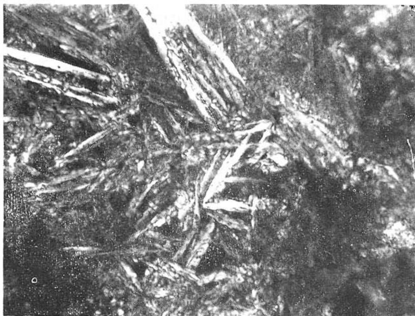
Рис. 9. Скелетообразная до фасцикулярной структура в крипнокристаллической материковой частицы. Видно расщепление плагиоклазовых кристаллов и слабых метаморфизм по форме зерен мафитов. Класт в реголитовой стекловатой брекчии из Луны 20. Фрагмент 20-20153, увел. 540 х, без анализатора. Фото В. Матейкова.
