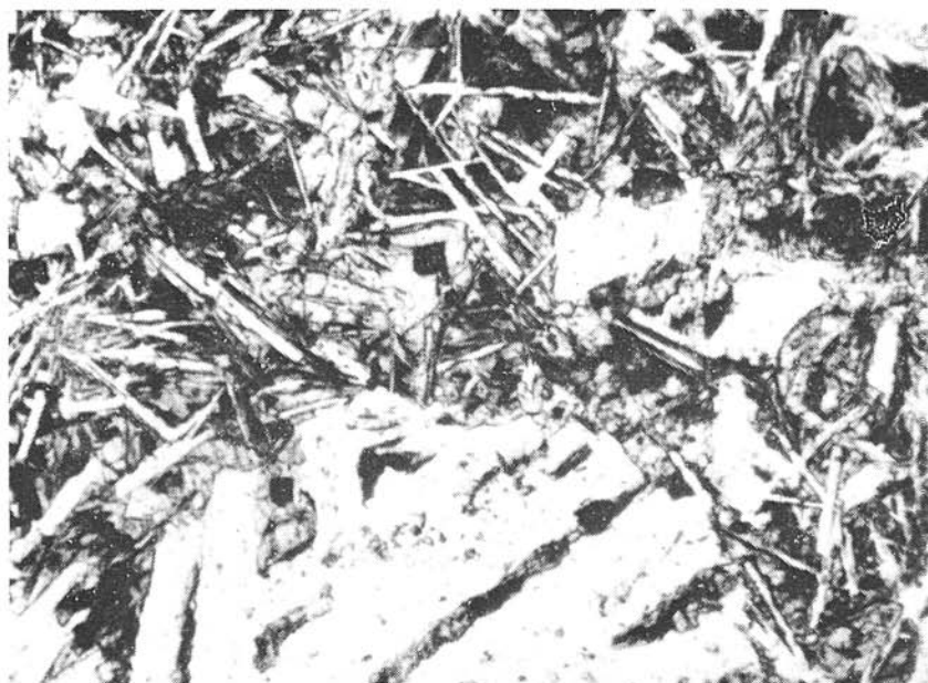
Рис. 3. Грубозернистая офитовая (идiomорфно-зернистая) структура анортозита, который включен в мелкозернистом интерсертальном «не-морском» базальте Луны 16. Фрагмент 16-2019, увел. 220 х без анализатора. Фото В. М а т е й к о в а.
