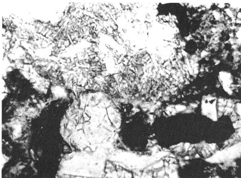
Рис. 8. Гломеробластическая игольчатая структура катакlastической анортозито-габброидной породы, которая включена в виде класта (верхняя часть фотографии) в мафической реголитовой брекчии Луны 16. Другой пример аналогичного генетического типа как в рис. 7. Фрагмент 16-3014, увел. 490 х, без анализатора. Фото В. Матейкова.
